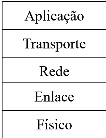
a. Pilha de protocolos da Internet de cinco camadas
